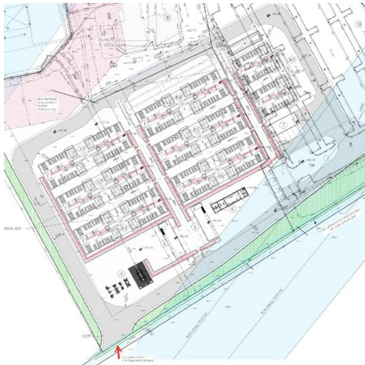
**Abbildung 6: Lageplan 28 x 4 MW<sub>el</sub> Gasmotorenanlage**
