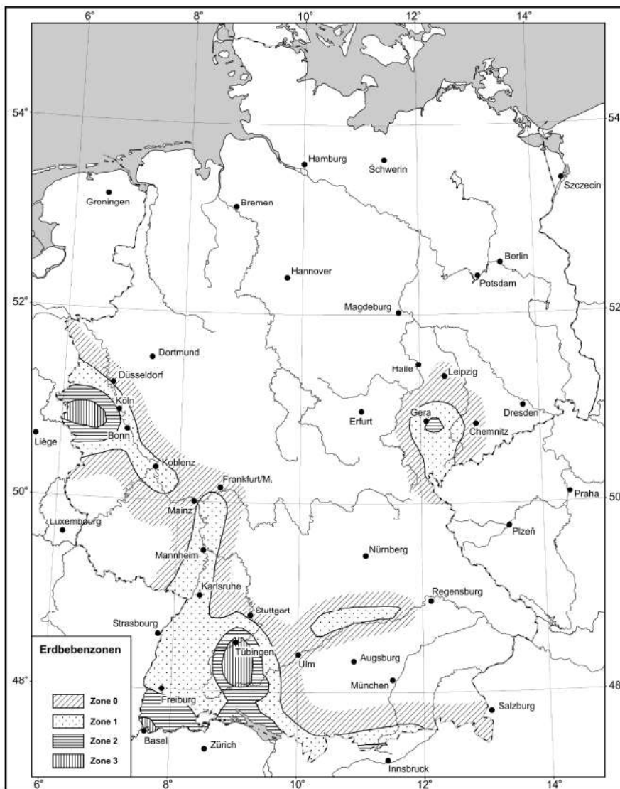
Abbildung 8: Erdbebenzonen in Deutschland gemäß DIN EN 1998-1/NA (2011-01). /10/
