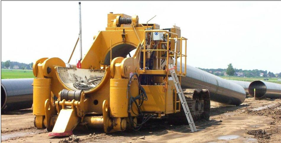
Abbildung 12      Biegemaschine
