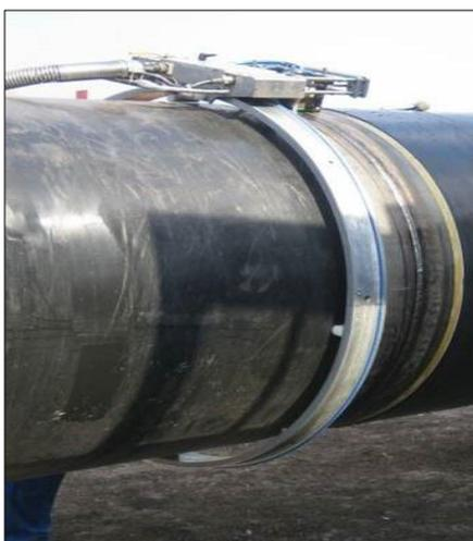
Abbildung 20 Prüfen der Schweißnähte mittels Ultraschall- / Durchstrahlungsprüfung
