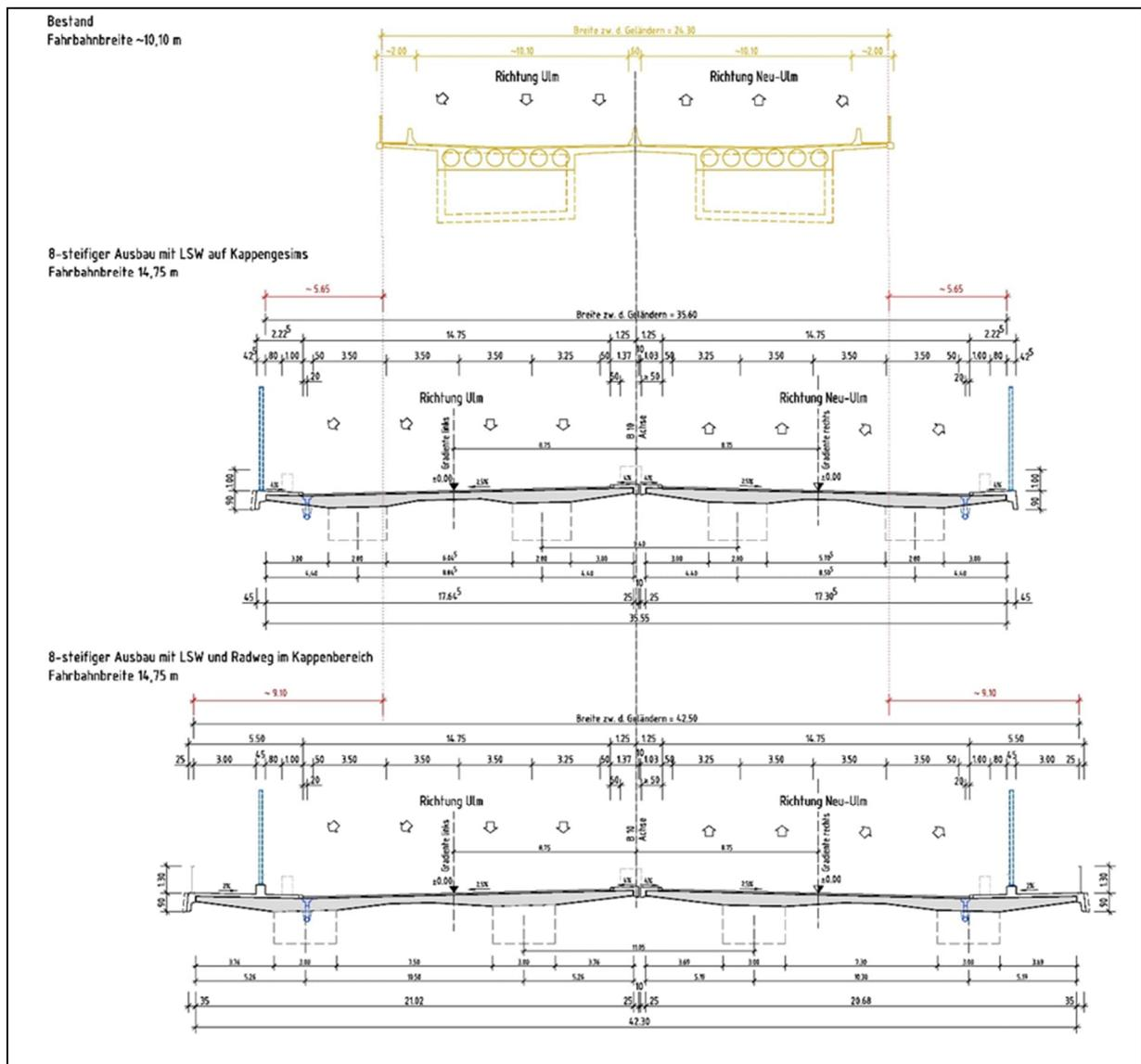
Abbildung 7: Regelquerschnitt – Variante 8-streifiger Ausbau
