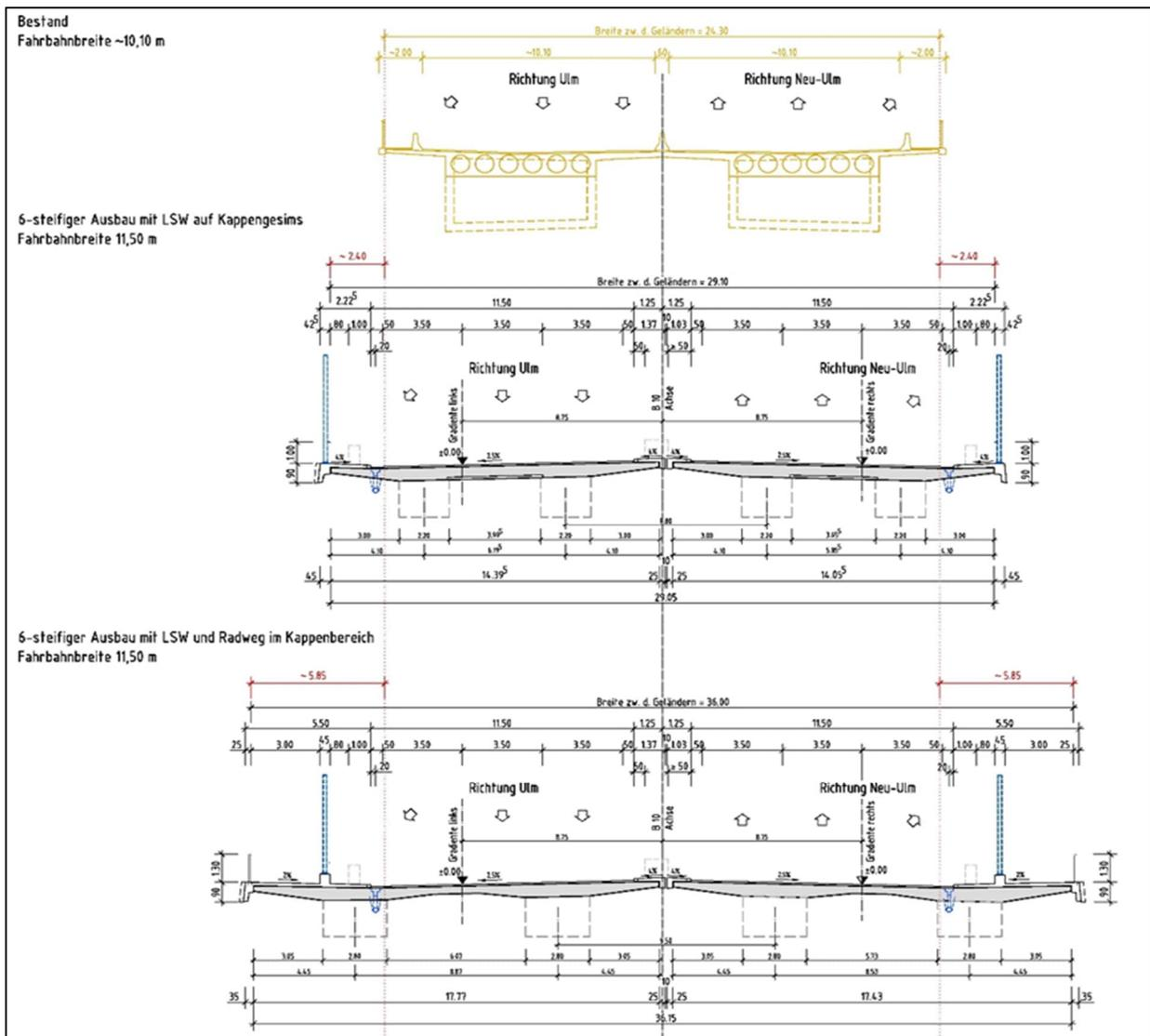
Abbildung 6: Regelquerschnitt – Variante 6-streifiger Ausbau
