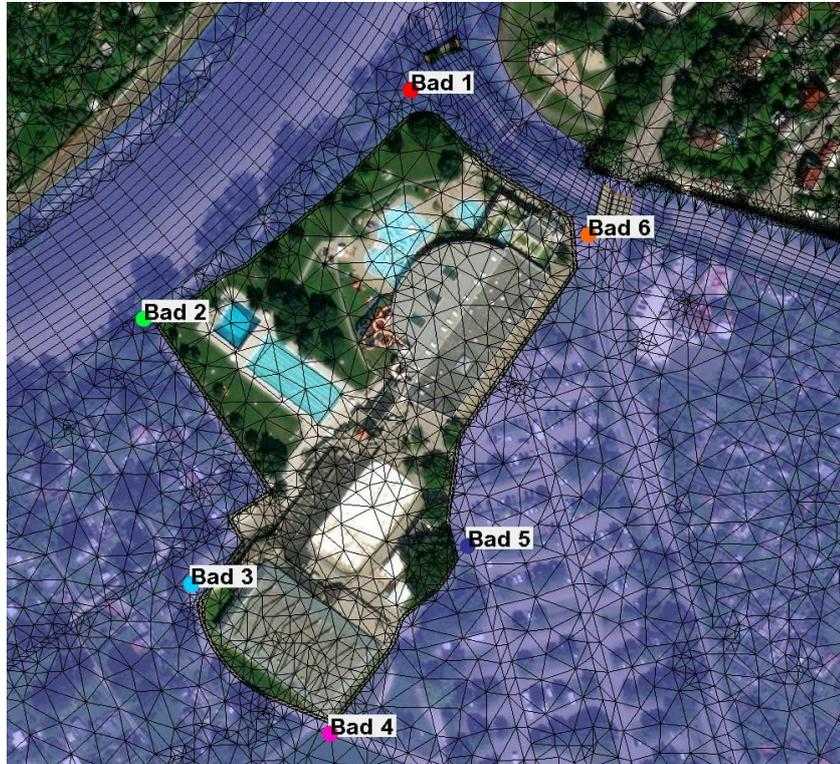
Abb. 9: Lage Vergleichspunkte Donaubad mit hinterlegter Wassertiefe HQ100
