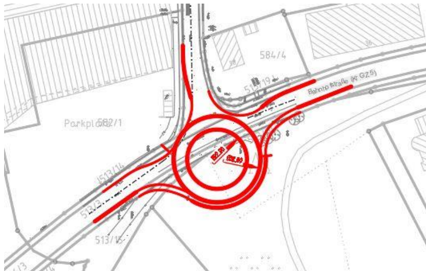
Abbildung 5: Untervariante Kreisverkehr bei ca. Stat. 0+100
