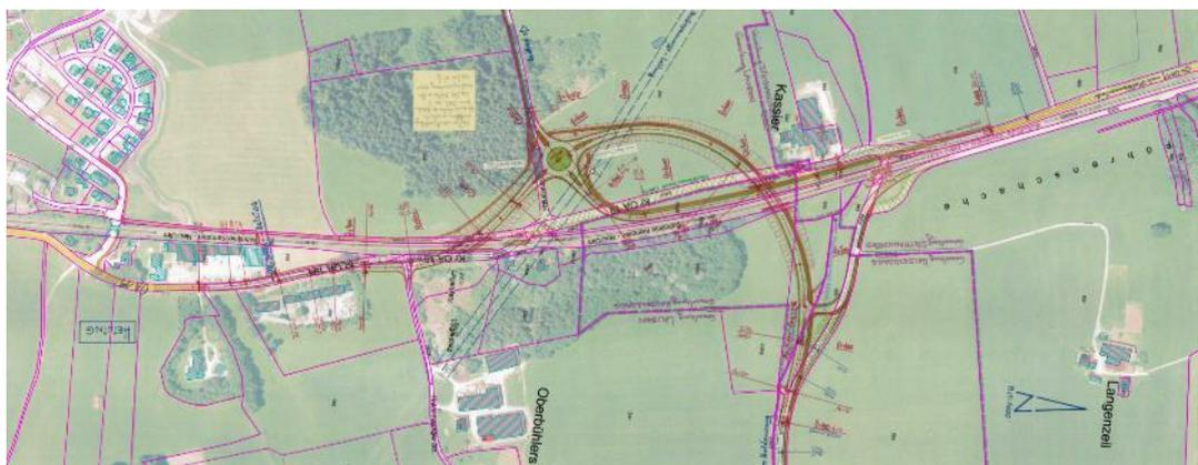
**Abbildung 3: Skizze Variante 3: Kreisverkehr westlich der Bahn**
