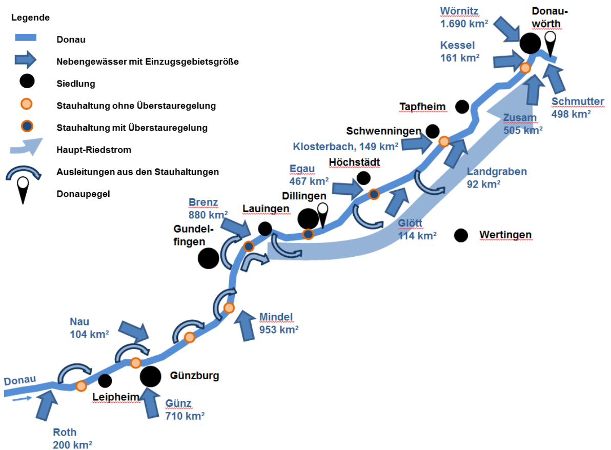
Abbildung 5: Schematische Darstellung des betrachteten Donauabschnittes
