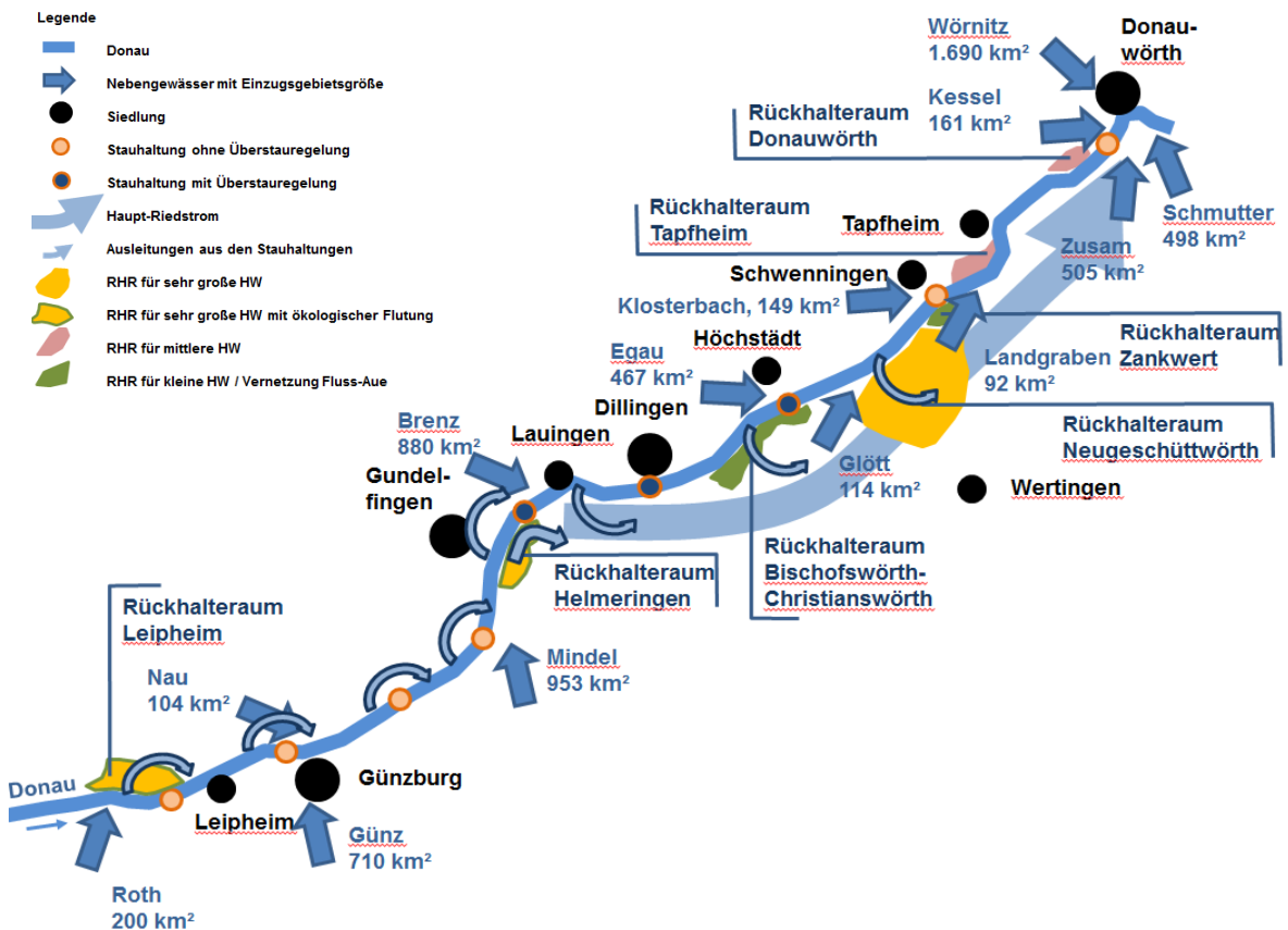
Abbildung 10: schematischer Übersichtsplan des Projektgebietes mit den konzipierten Rückhalteräumen und wesentlichen Projektteilzielen
