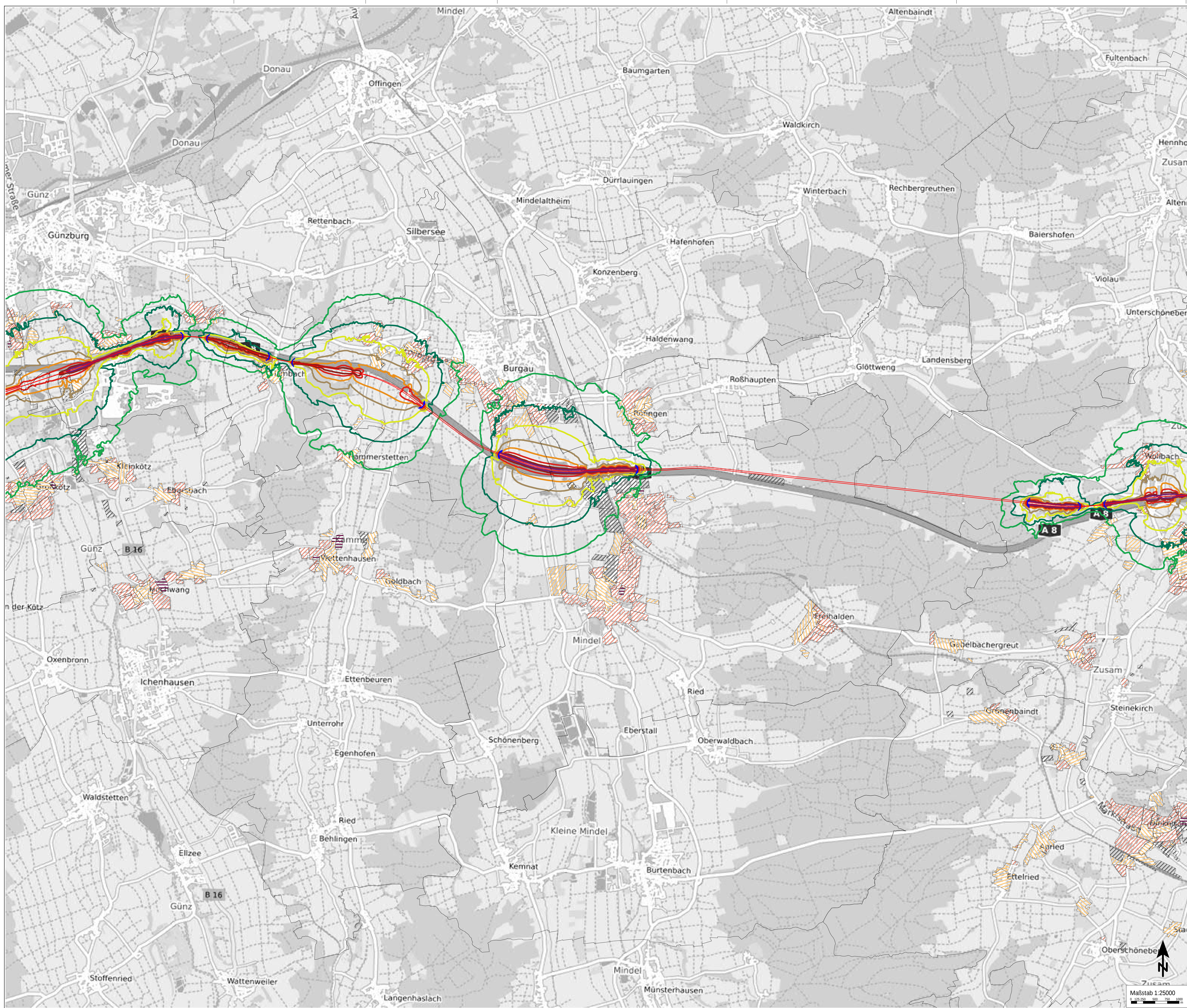
Isophonenkarte Raumordnungsverfahren NBS/ABS Ulm-Augsburg Variante Orange Tiefbahnhof Zusamtal, Beurteilungspegel Tag Anlage_Orange Tiefbahnhof Zusamtal_1_2
